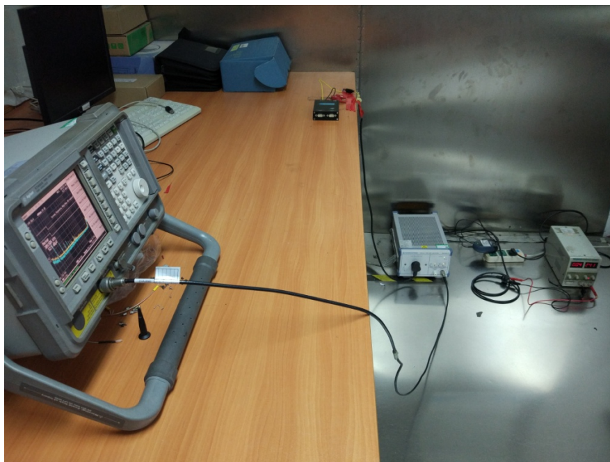
图 7 传导骚扰试验配置
